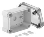
Kabelabzweigkasten zum Verbinden von Kabeln und Leitungen im Innen- und Außenbereich. Rechteckige Form ohne Einführungen. Geeignet für die Wand-/Deckenmontage mit der Möglichkeit zur Außenbefestigung, Innenbefestigung oder Montage über die Eckdome. Besonders schlagfest mit IK08. Transparenter Deckel mit Schnellverschluss, plombierbar. Hergestellt aus halogenfreien und UV-beständigen Materialien.
